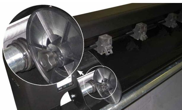
FIG 1-19 POSITIE ROL BIJ GEBRUIK MEDIAFLENZEN
