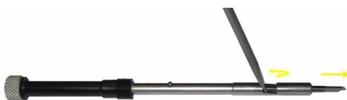
FIG 1-29 VERWIJDEREN VAN HET MESJE UIT DE HOUDER
