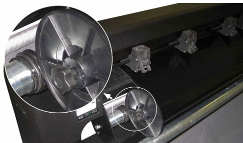
ABB 1-19 POSITIONIEREN DES MATERIALS -SPURKRANZES AM SCHNEIDEPLOTTER
