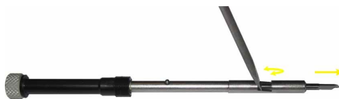
ABB 1-29 ENTFERNEN DES MESSERS VOM TANGENTIALEN MESSERHALTER
