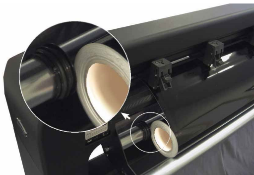
ABB 1-20 EINFÜHREN EINER MATERIALROLLE OHNE FLANSCH
