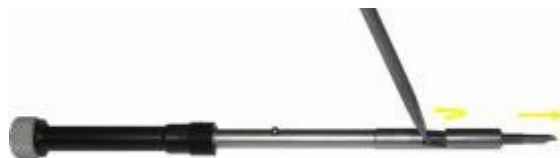
FIG 1-29 RIMOZIONE DELLA LAMA DAL PORTALAMA TANGENZIALE
