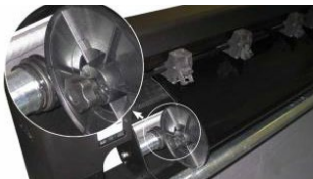
FIG 1-19 POSIZIONAMENTO DELLE FLANGE PORTA ROTOLO SUL PLOTTER
