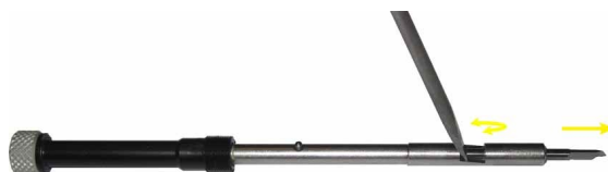
FIG 1-29 RETRAIT DE LA LAME DU PORTE-LAME TANGENTIEL
