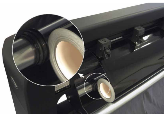
FIG 1-20 POSITION DU ROULEAU SANS UTILISATION DES FLASQUES
