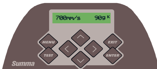
FIGURA 1-13 MATERIAL CARREGADO E CORTADORA PREPARADA
