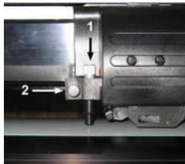
FIGURA 1-25 CARROSSEL DE FERRAMENTA COM PORTADOR DE LÂMINA E BRAÇADEIRA
